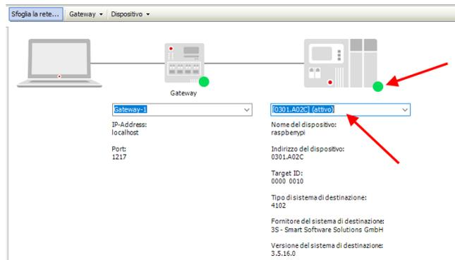
Ora che il PLC è stato rilevato possiamo ad inserire una porta profinet su ethernet standard:
