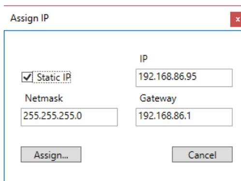
Il software funziona sul layer 2 e non è quindi necessario avere una configurazione ethernet compatibile con il dispositivo che si sta cercando.
