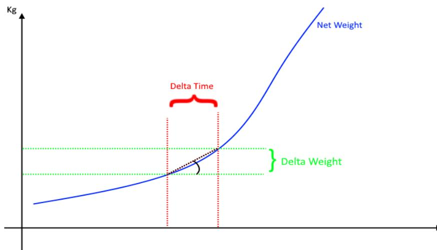
Verrà richiesto di inserire i valori di Delta Peso Netto (**Delta Weight**) (in unità ingegneristiche) e di Delta Tempo (**Delta Time**) (in quanti 0.1 secondi).
