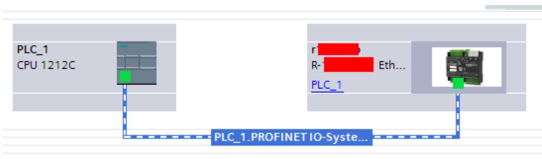
Ora facciamo click due volte sul dispositivo Seneca e andiamo a configurare anche qui l'indirizzo IP (ad esempio 192.168.90.48):
