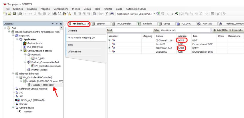
Dichiariamo una variabile a 16 bit (Word) per i 16 ingressi e un byte per le 8 uscite.
